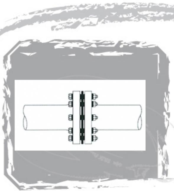
**Raccordement de bride en tant que point de rupture électrique qui évite la corrosion par contact.**
