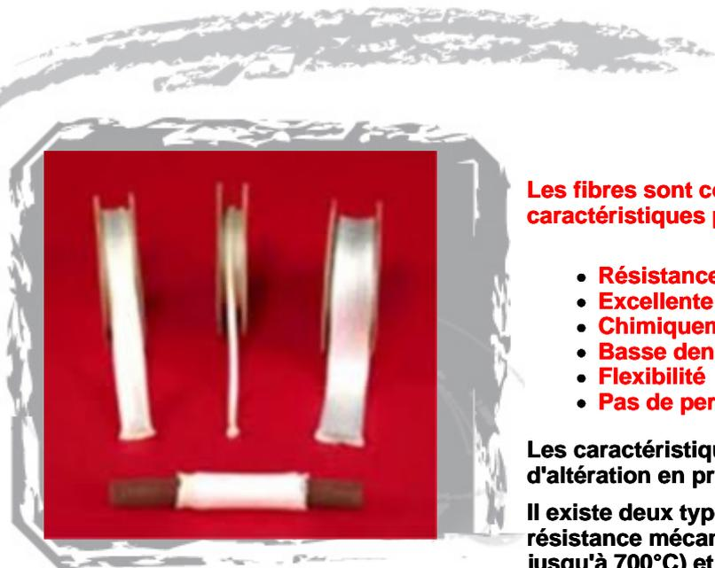
Les fibres sont composées de silicate d'aluminium dont les caractéristiques principales sont les suivantes :
