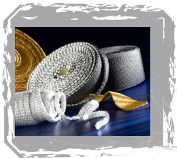
**Les produits textiles en verre sont constitués principalement de fils de 6-9 microns qui ont subi un processus successif de torsions, mises en volume et texturations. Il s'agit de produits sans amiante. Employés pour des applications industrielles dans lesquelles sont nécessaires de fortes résistances mécaniques et thermiques avec des températures jusqu'à 500°C.**
