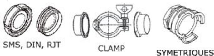
Le montage coté tuyau pourra être **serti, à coquilles, avec collier ou à dudgeonner.**
