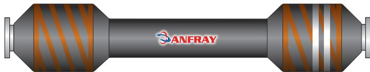
21180 FSC - FPSO Extrémité renforcée haute flottabilité (ex : en sortie de FPSO vers le support ERC)
