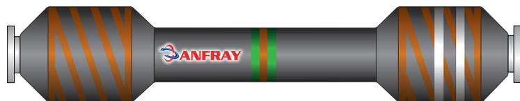
22180 FDC - FPSO - Extrémité renforcée - haute flottabilité (ex : en sortie de FPSO vers un support ERC)
