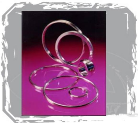
Les joints annulaires sont constitués d'un anneau métallique usiné. **Ils sont destinés aux applications à hautes températures et hautes pressions et sont toujours utilisés en association avec des brides spéciales munies de gorges usinées.**
