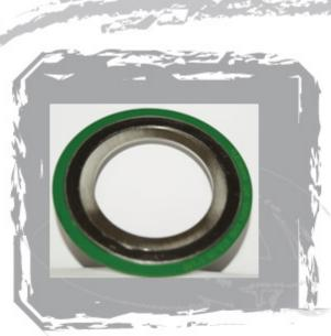
Le joint spiralé se compose d'un feuillard métallique nervuré enroulé en spirale et d'un garnissage en graphite, PTFE ou mica, enroulé entre chaque spire.
