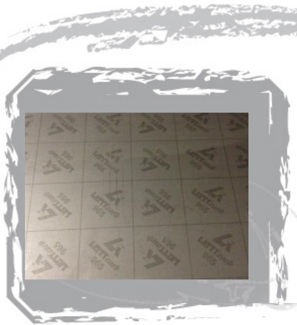
**Joint constitué de fibres de carbone et minérales sélectionnées, liées avec un mélange d'élastomères synthétiques et comprimées en feuilles. Le joint est renforcé par un treillis métallique interne. Un graphitage spécifique appliqué sur les deux faces de la feuille rend les opérations de démontage extrêmement rapides et permet de minimiser les risques de corrosion de la bride.**
