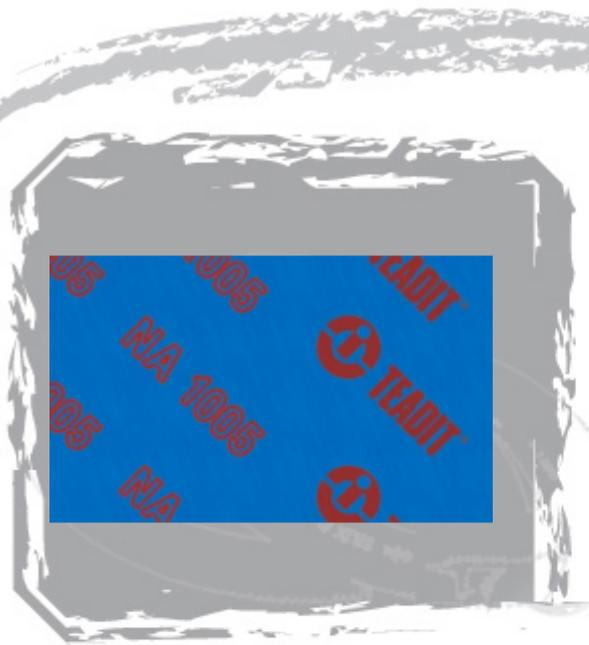
**TEADIT style NA 1005** est produite à partir de fibres d'aramide et de caoutchouc nitrile (NBR). Elle est fabriquée au moyen d'un processus de calandrage à chaud. La fabrication se fait sous contrôle permanent des paramètres qualité définis par TEADIT : contrôle épaisseur, contrôle tolérances et contrôle températures. **Certification ISO 9001.**
