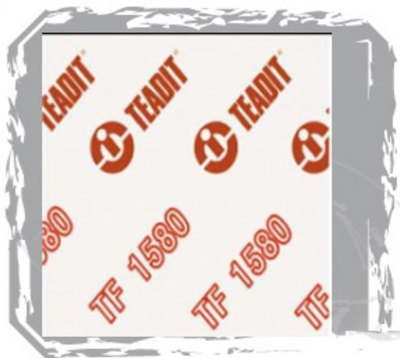
**TEADIT TF 1580** est un PTFE structuré - Joint d'étanchéité - Feuilles fabriquées suivant un procédé unique qui offre un haut niveau de la fibrillation, qui limite le fluage à froid et les pertes de serrage généralement relevés sur les joints en PTFE vierge. La feuille TEADIT TF1580 est produite à partir de résine PTFE chargée sulfate de BARIUM.
