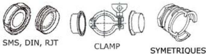
Le montage côté tuyau pourra être **serti, à coquilles, avec collier, ou à dudgeonner**.
