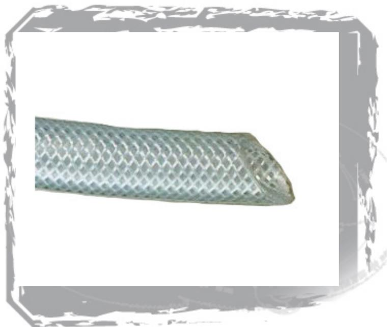
Tuyau souple polyvalent en PVC, renforcé par tresse textile de haute ténacité, destiné au refoulement de produits liquides alimentaires ou industriels, air comprimé,...
