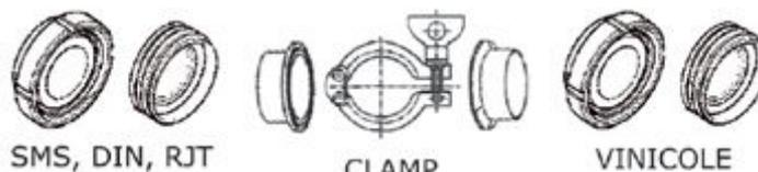
Le montage côté tuyau ne peut être fait à sec, il faut utiliser des colliers ou des douilles.
