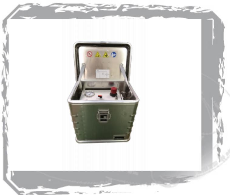
En centrale nucléaire, cet outillage spécifique permet de pressuriser l'actionneur du robinet pneumatique lors de l'accouplement et du désaccouplement de ce dernier.
