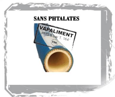
Tuyau souple en caoutchouc EPDM de qualité alimentaire spécialement conçu pour le nettoyage à l'eau chaude ou à la vapeur. Convient également pour le transfert et le refoulement de tout produit alimentaire à haute température. La paroi épaisse sans spire metallique a été développée pour les enrouleurs et permet de limiter le phénomène de déformation dans le temps.
